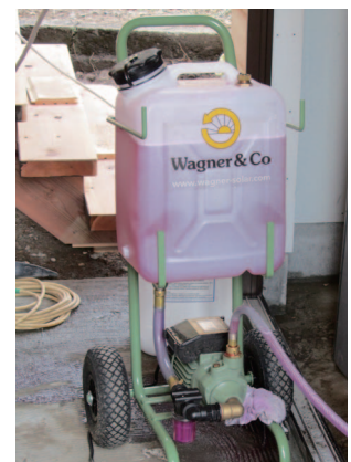
左から床暖房回路の循環ポンプキット、小屋内の配管や器具の接続状況、密閉回路に不凍液を注入する移動式ポンプ
